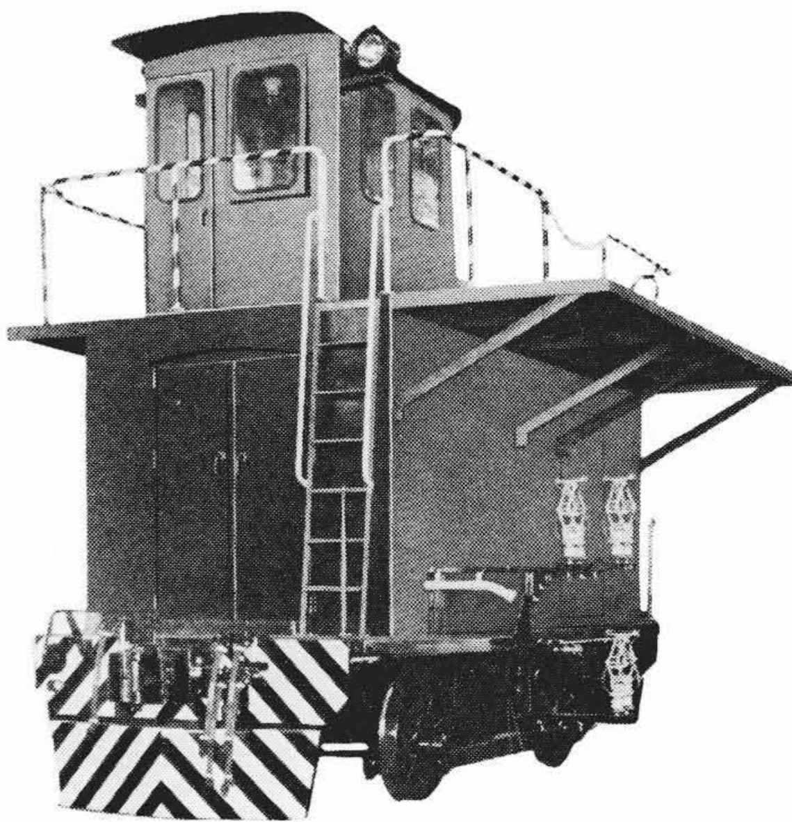
第19図 日本鋼管株式会社水江製鉄所納 18t消火車けん引用電気機関車
