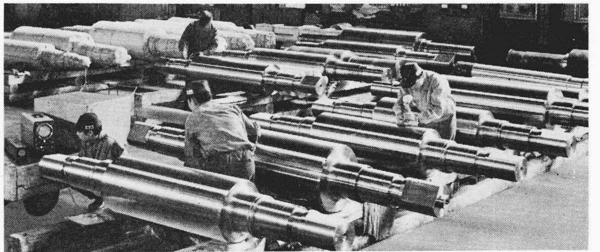
第16図 大形鍛鋼焼入れロールの完成状況
