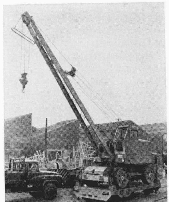
第8図 台車付M23Rモバイルクレーン
