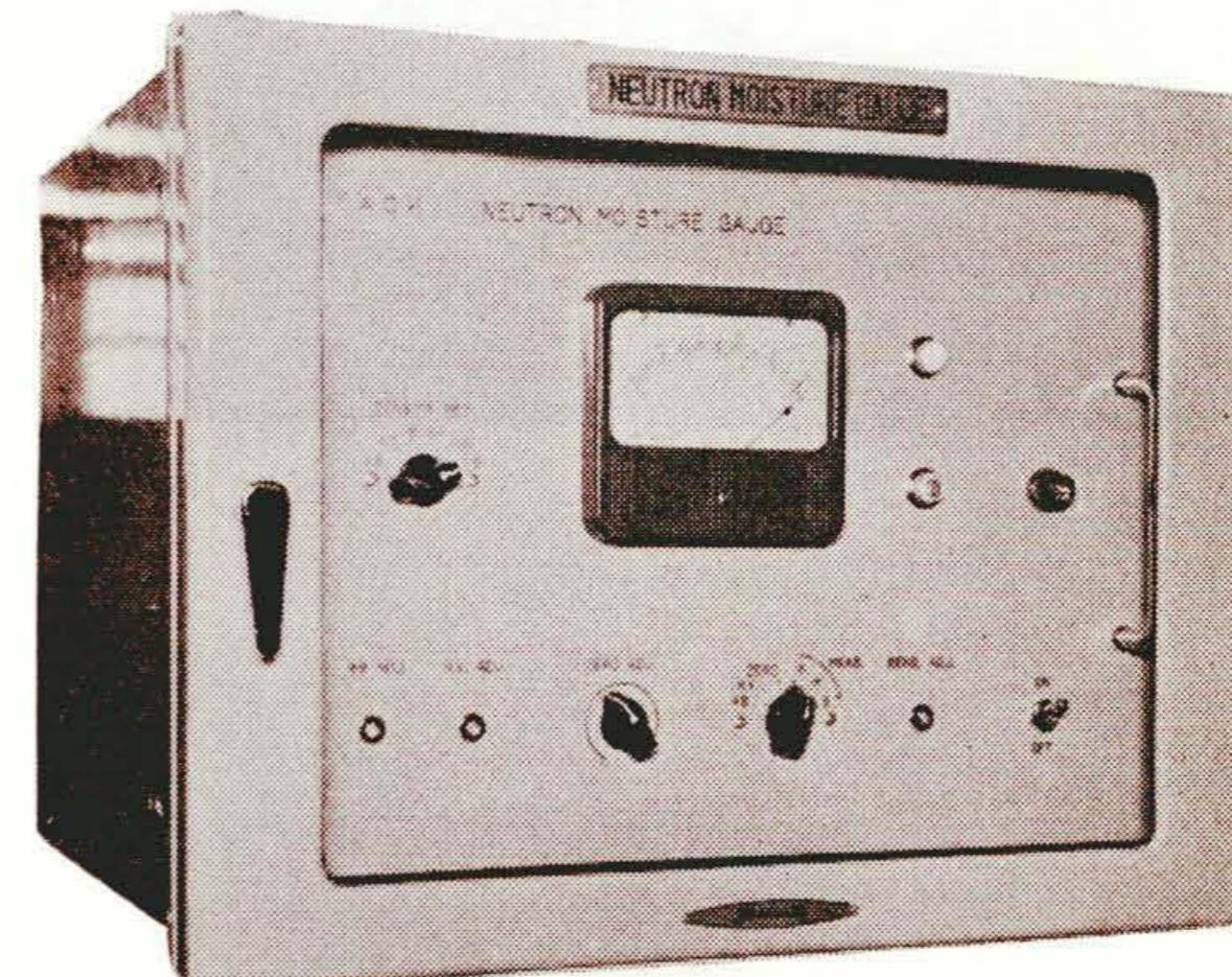
第16図 工業用中性子水分計の電子管回路部
