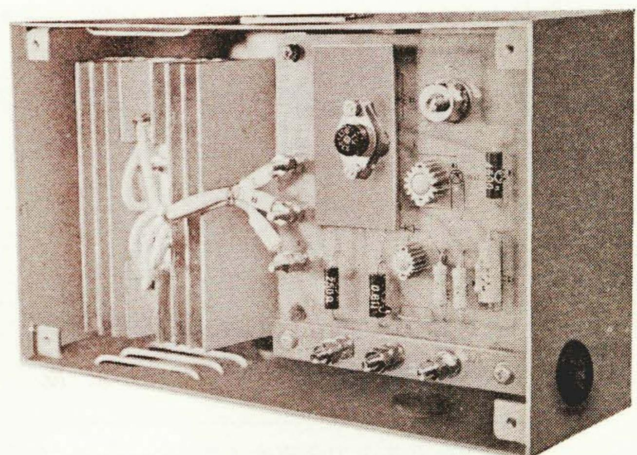
第7図 AVR-2 形定電圧装置
