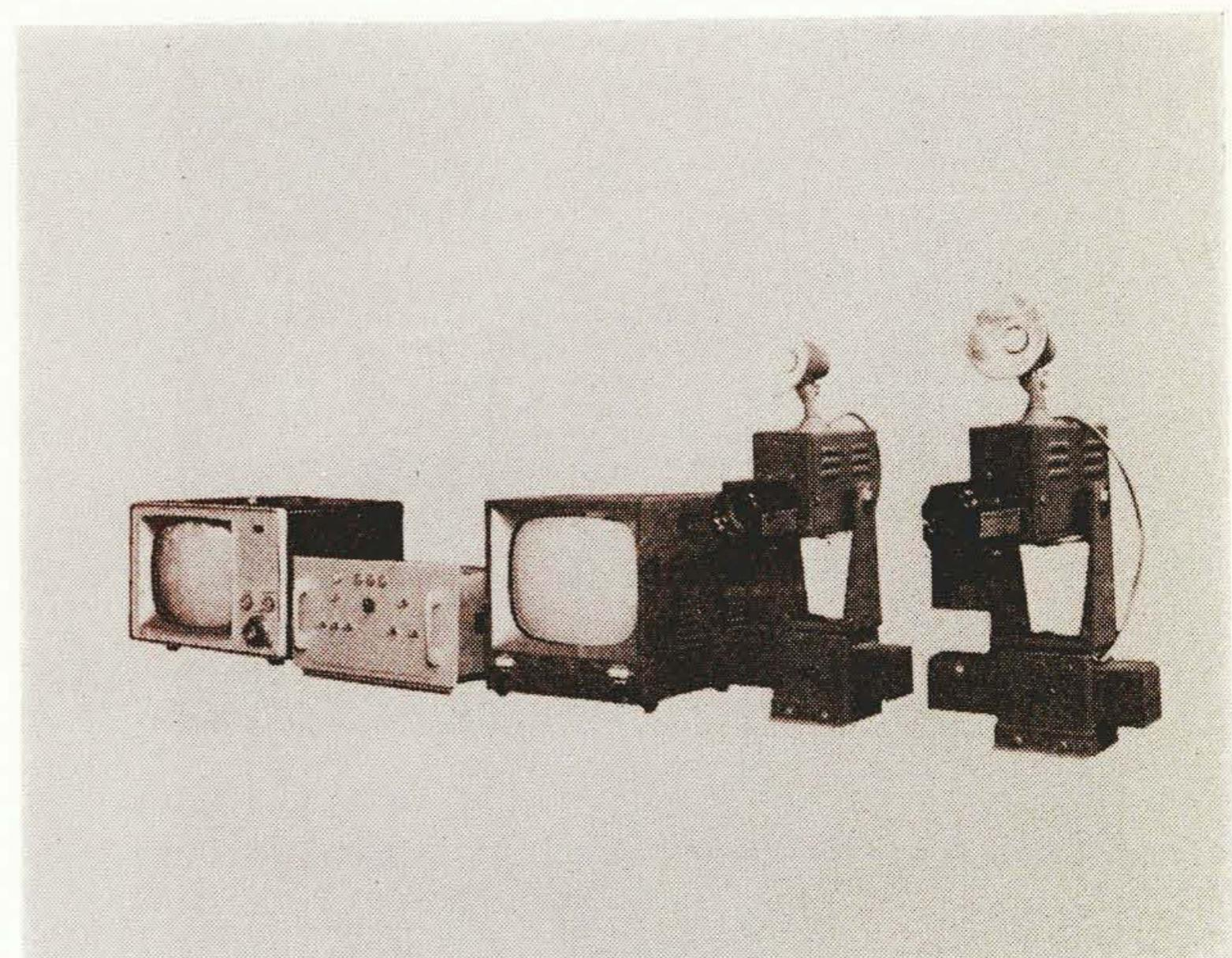
第12図 向かって左から FY-940 テレビ、カメラ切替制御器、TIM-6 モニタ、TIC-4 カメラと首振雲台およびズームレンズ
