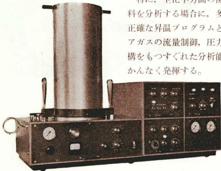
第8図 Model F6 高性能昇温ガスクロマトグラフ
