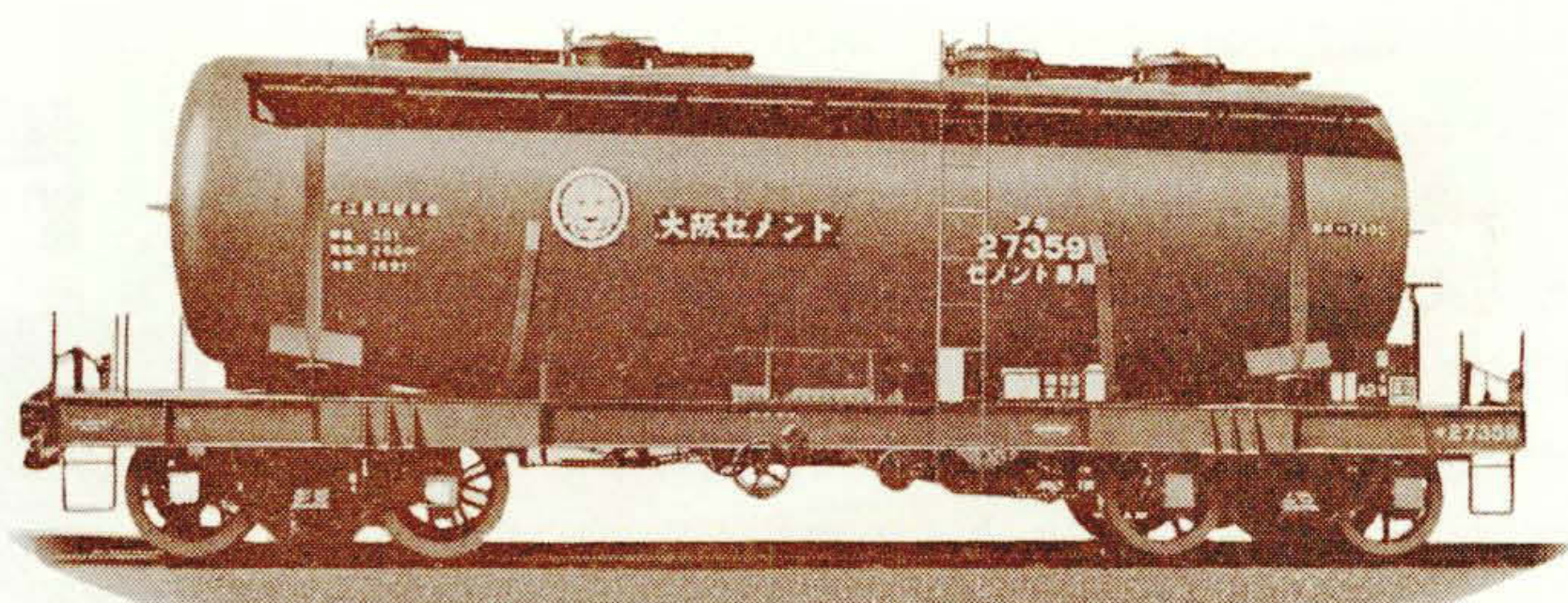
第 18 図 大阪セメント株式会社納 35 t 積セメントタンク車
