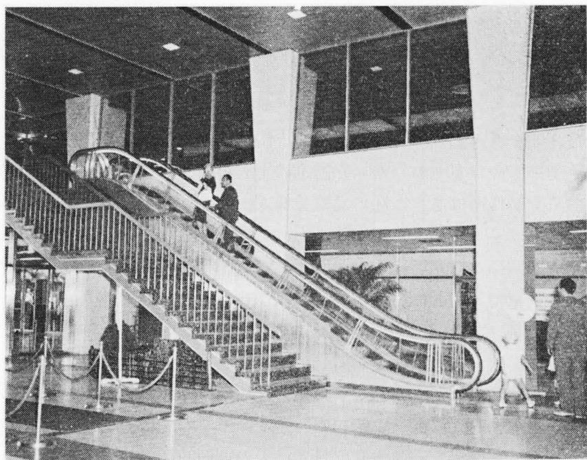
第21図 NN-W<sub>1</sub>形ハンドレール新駆動方式の全透明式エスカレータ
