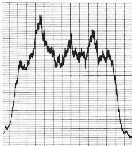
(c) ウランの  $\gamma$  線測定法第 8 図 U-Al 合金板状燃料体のウラン分布測定例
