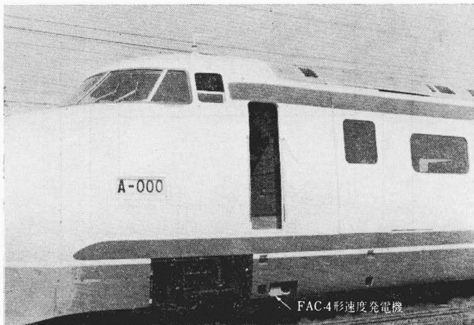
第5図 新幹線試作車の FAC-4 形発電機取付状態
