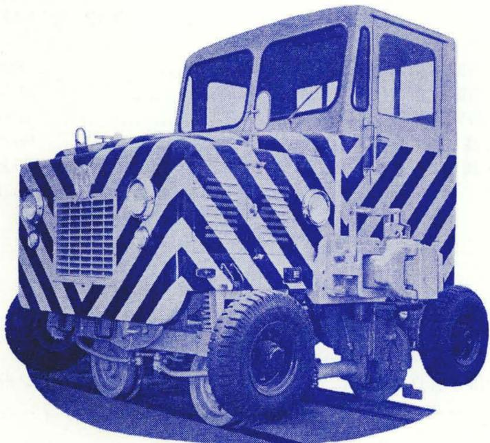
第 4 図 京王帝都電鉄株式会社納ロードレールトラクタ
