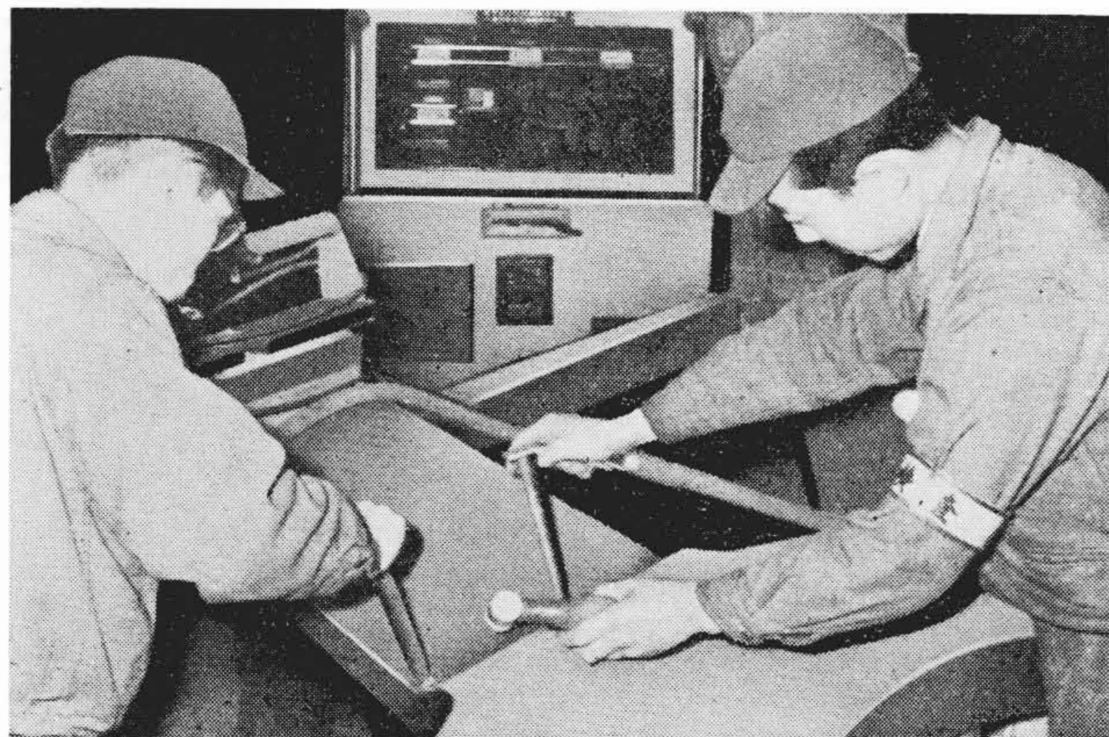
第3図 溶接部磁粉探傷
