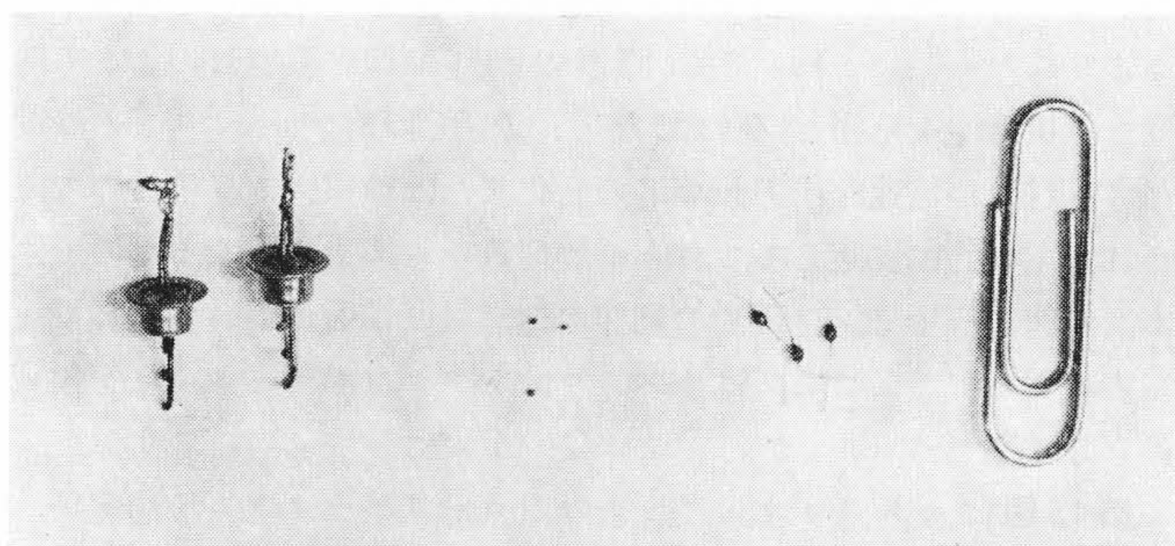
右より VB-1, VB-3, VB-3A 第 19 図 ガス分析用サーミスタ
