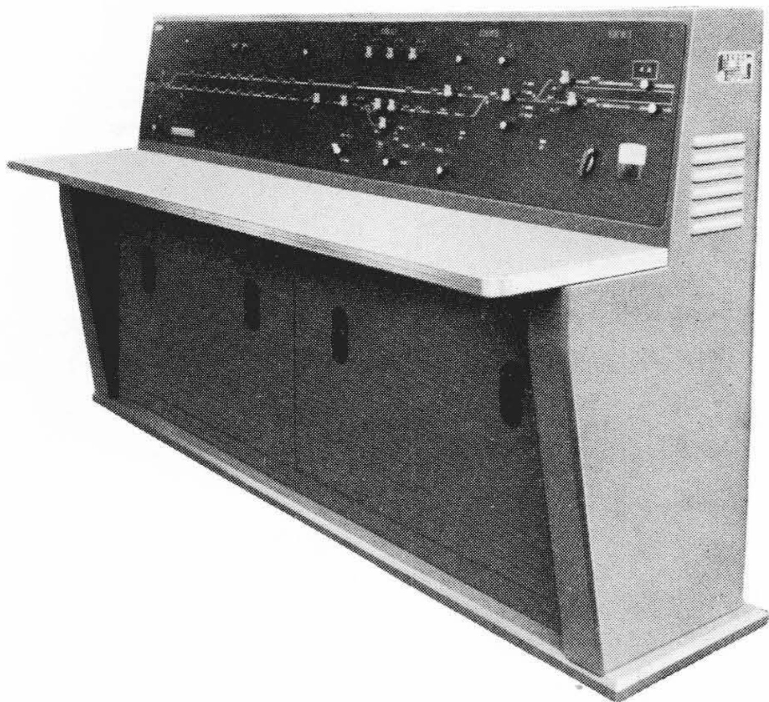
第 13 図 中央運転指令所に設備した連動制御盤
