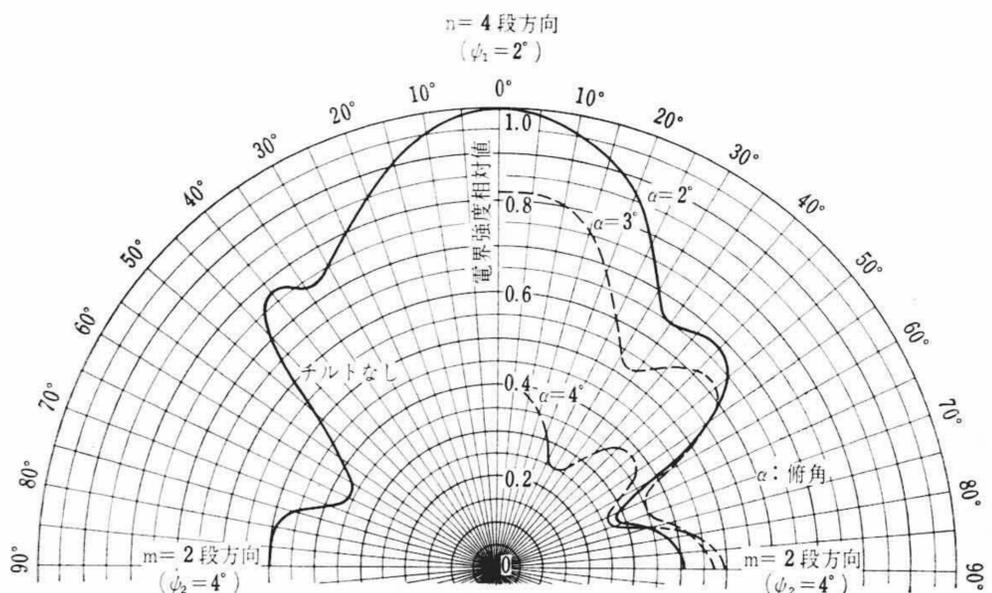
第11図  $\phi_1=2^\circ, n=4, \phi_2=4^\circ, m=2$  で6素子双ループアンテナを90°2面配置した場合の合成指向性
