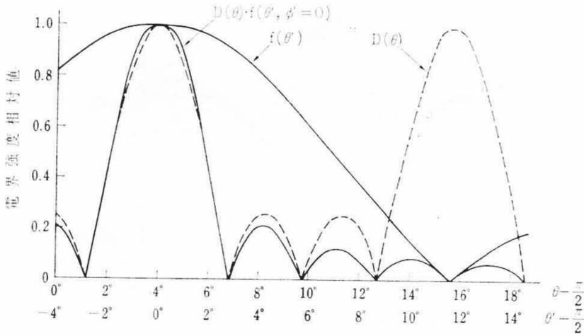
第10図 6素子双ループアンテナについて  $\phi=4^\circ$ ,  $n=4$  の場合の  $D(\theta)$ ,  $f(\theta)$ ,  $\phi'=0$ ,  $D(\theta) \cdot f(\theta)$ ,  $\phi'=0$
