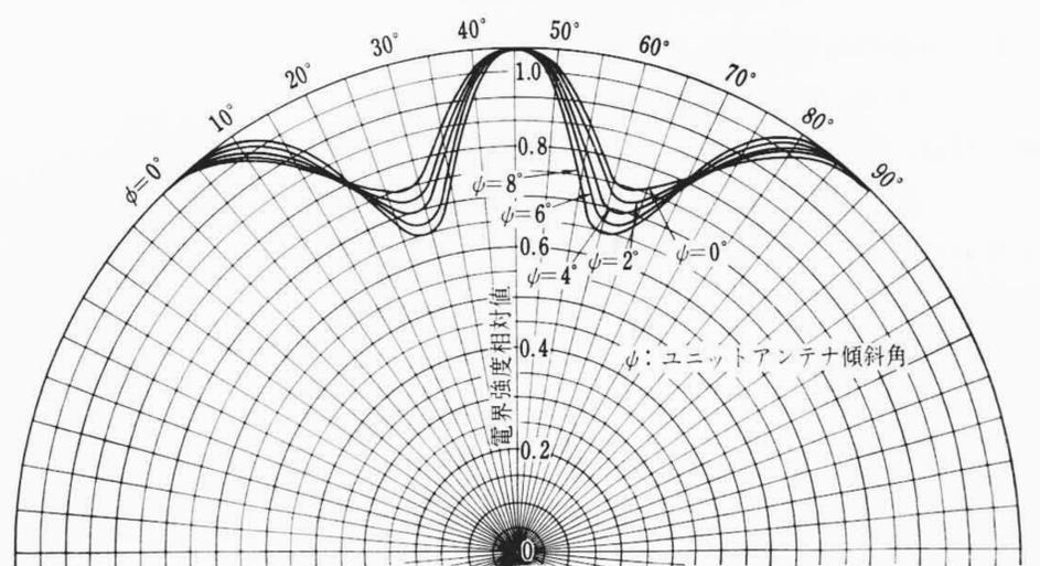
第9図  $n=m=1$ で $\psi$ が変化した場合の $90^\circ$ 2面配置合成指向性(4素子)
