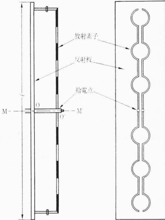
第5図 双ループアンテナの概略図
