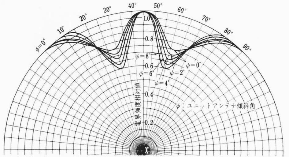
第6図  $n=m=1$ で $\psi$ が変化した場合の $90^\circ$ 2面配置の合成指向性(6素子)
