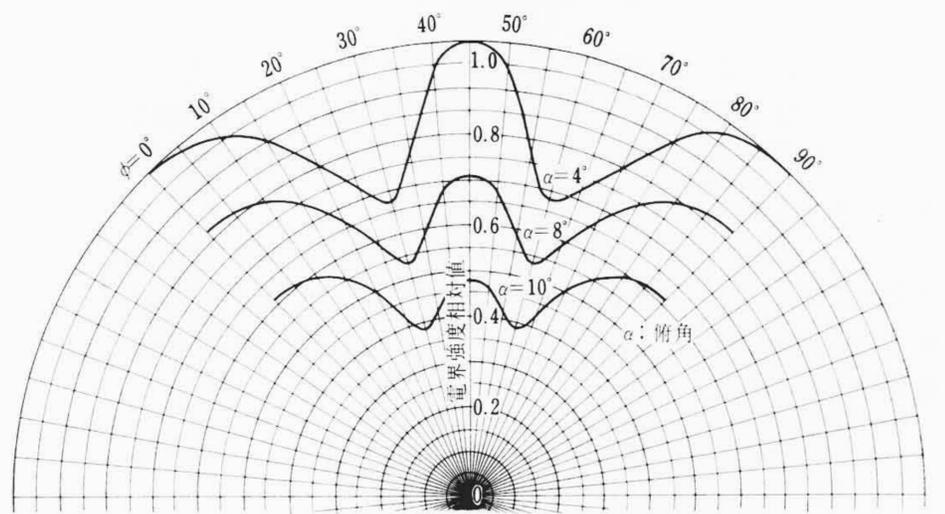
第8図  $n=m=1$ ,  $\psi=4^\circ$ で $\alpha = \theta - \pi/2$ をパラメータにした場合の $90^\circ$ 2面合成指向性(6素子)
