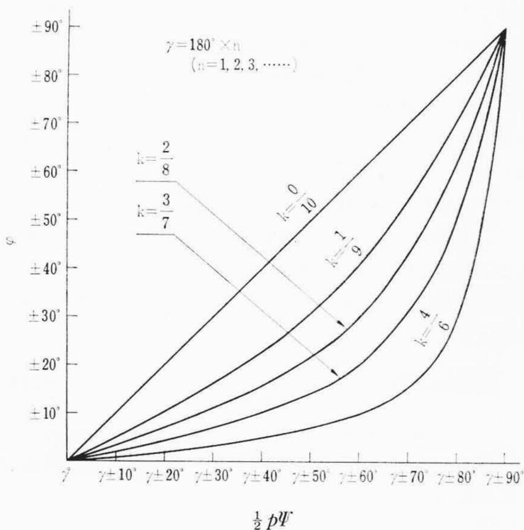
第12図 ヌルフィルインのための電力分配によって生ずる位相量  $\varphi$  と  $1/2 p\Psi$  の関係
