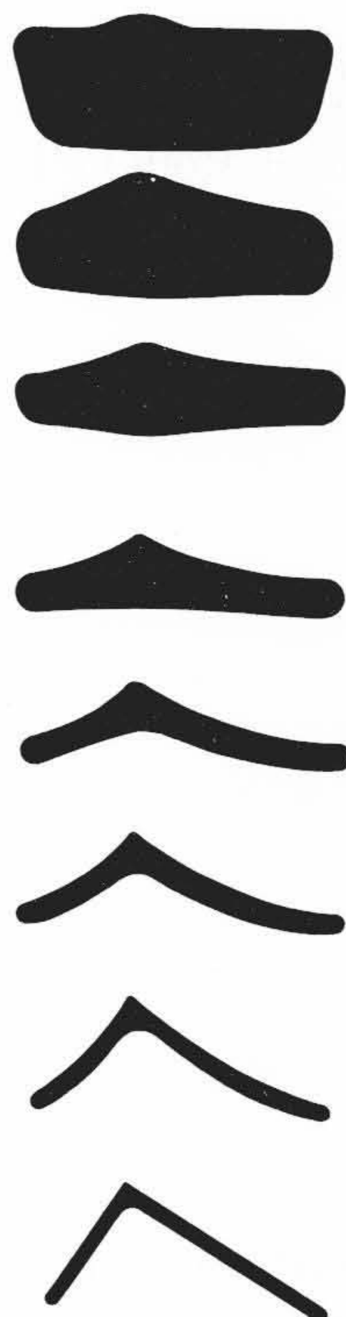
第2図(b) 各スタンドにおける 圧延材の形状 (スタンプ)
