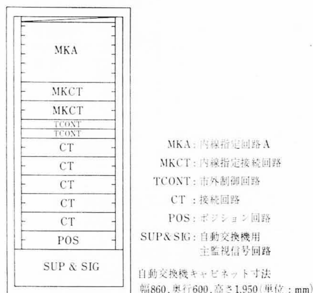
図9 バイルート式局線10回線、内線50回線以下の搭載例
