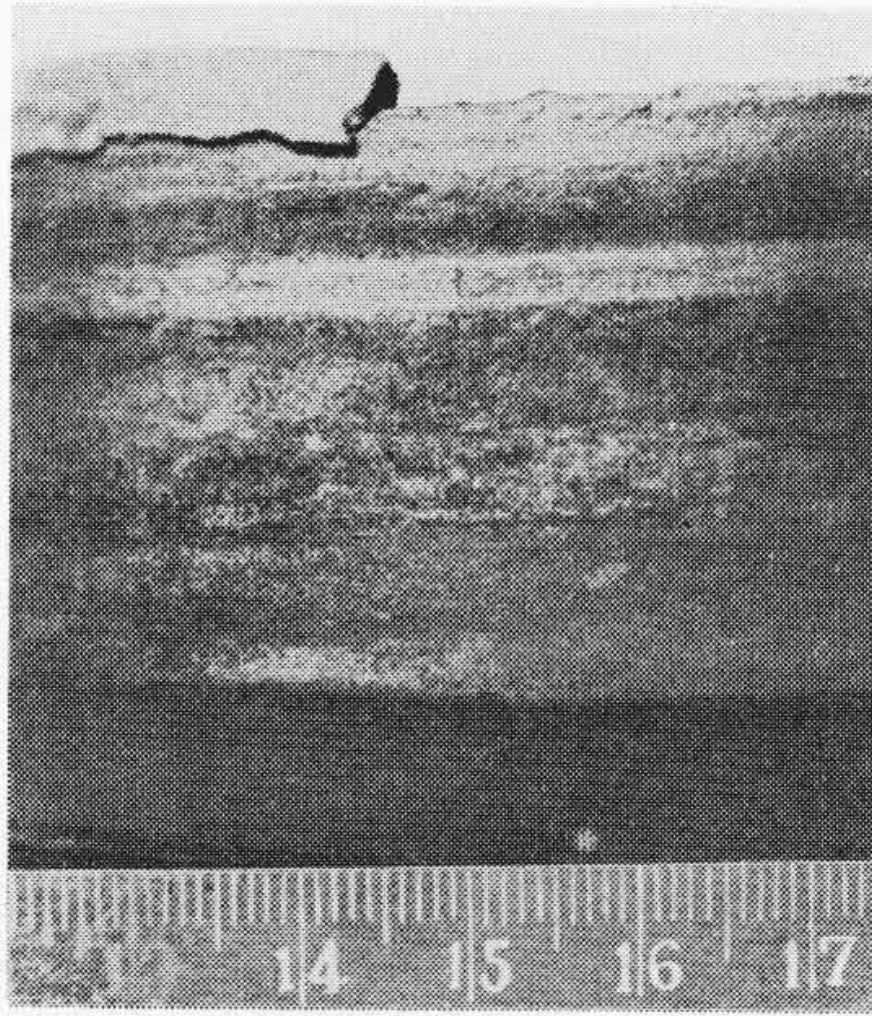
図 17 試験後の 2 JLMT 駆動部 内側車輪
