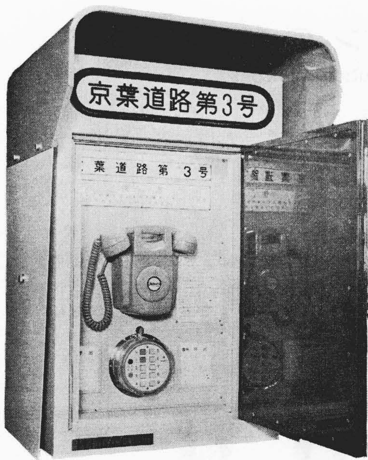
図 18 高速道路用非常電話機
