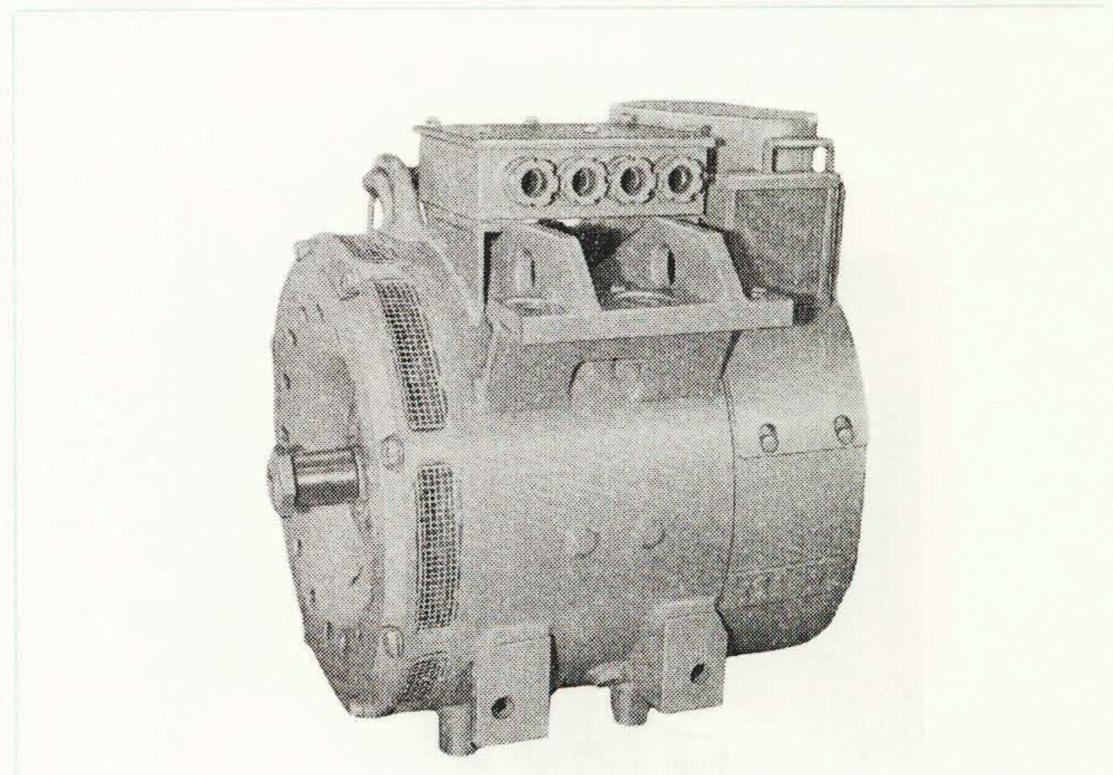
図8 電車用 95 kW 主電動機
