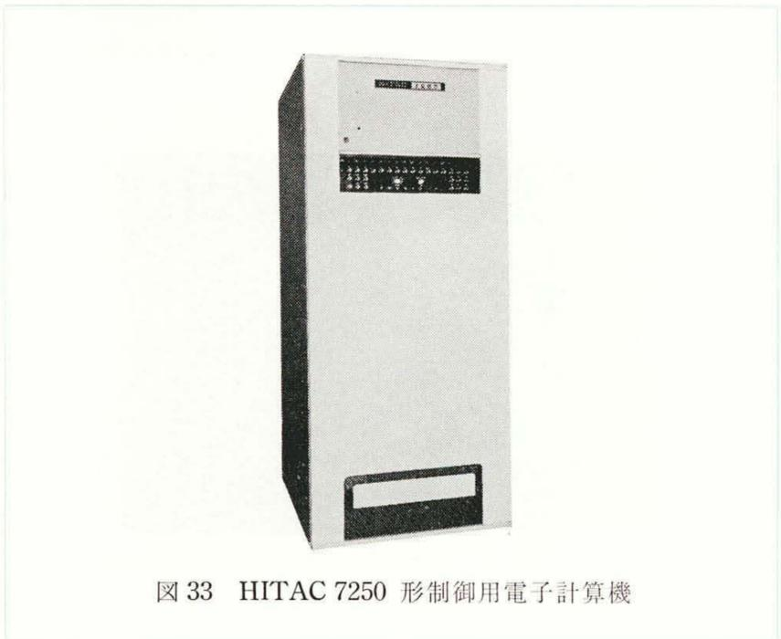
図33 HITAC 7250 形制御用電子計算機
