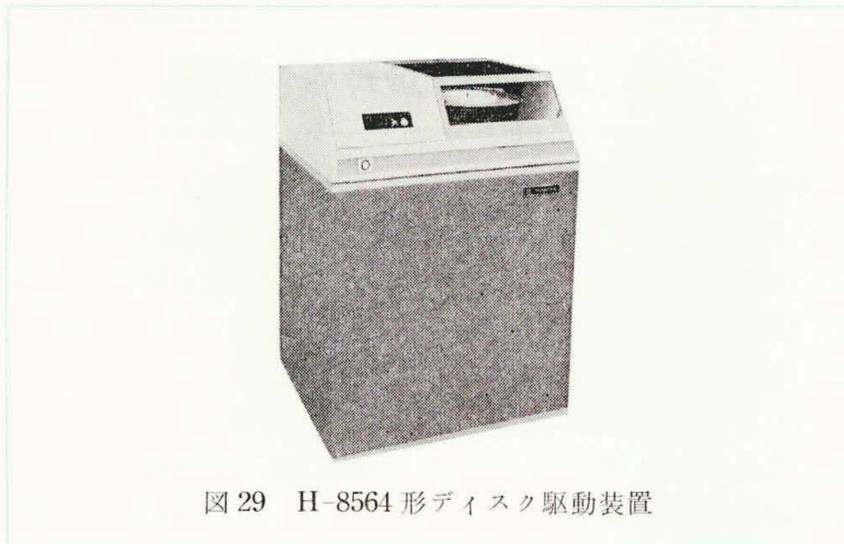
図 29 H-8564 形ディスク駆動装置
