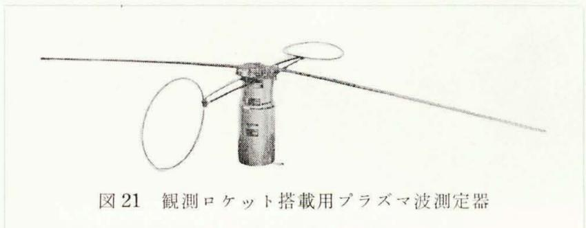
図21 観測ロケット搭載用プラズマ波測定器
