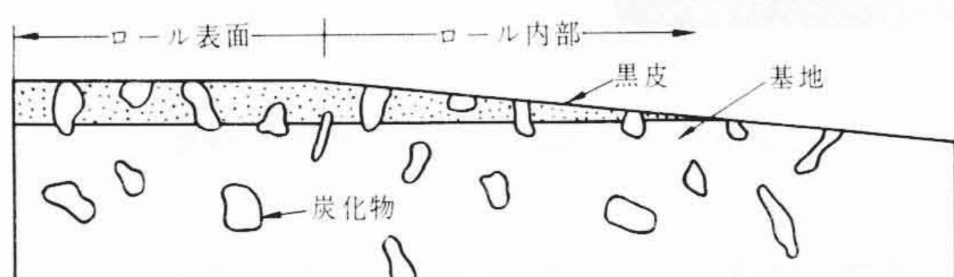
(b) (a)図の横方向垂直断面をモデル化したもの
