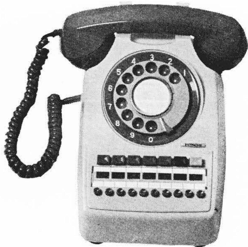
図 2 ボタン電話機を用いた 5 回線局線中継台
