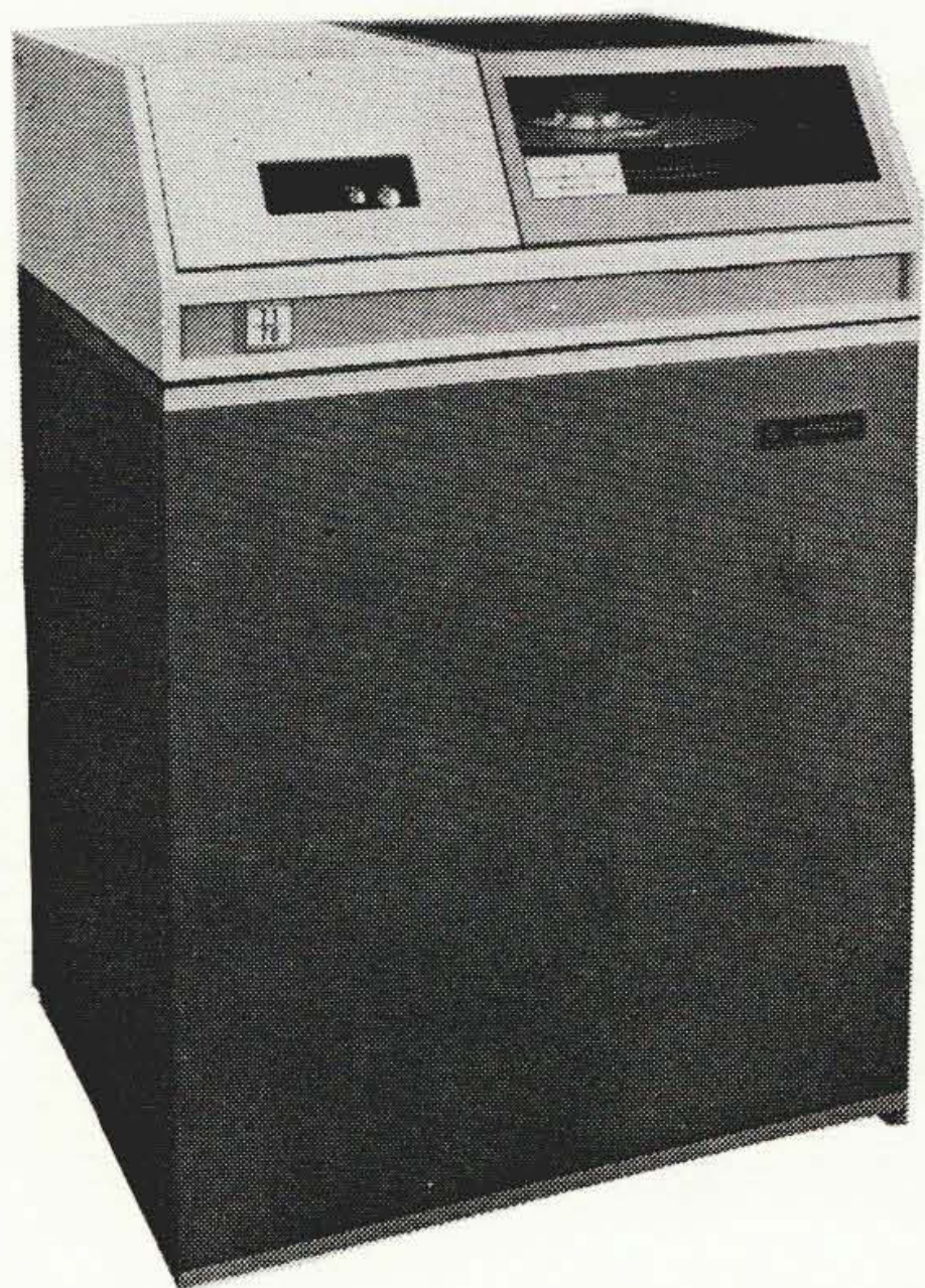
図29 H-8565 形ディスクパックを 2 個取り付けた H-8564-21 形ディスク駆動装置
