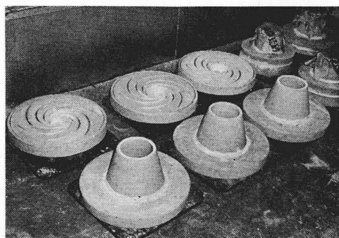
図16 造型後のセラミック鑄型 (ポンプ用インペラ鑄型)
