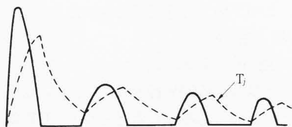
図22 突入電流と接合部温度( T_j )の変化
