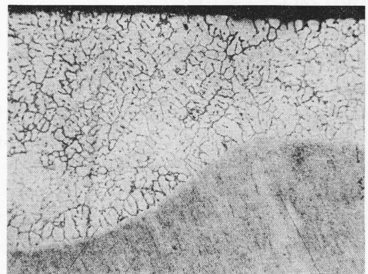
図4 No. 34 フラックスによるろうの広がり後の断面組織 (×50)
