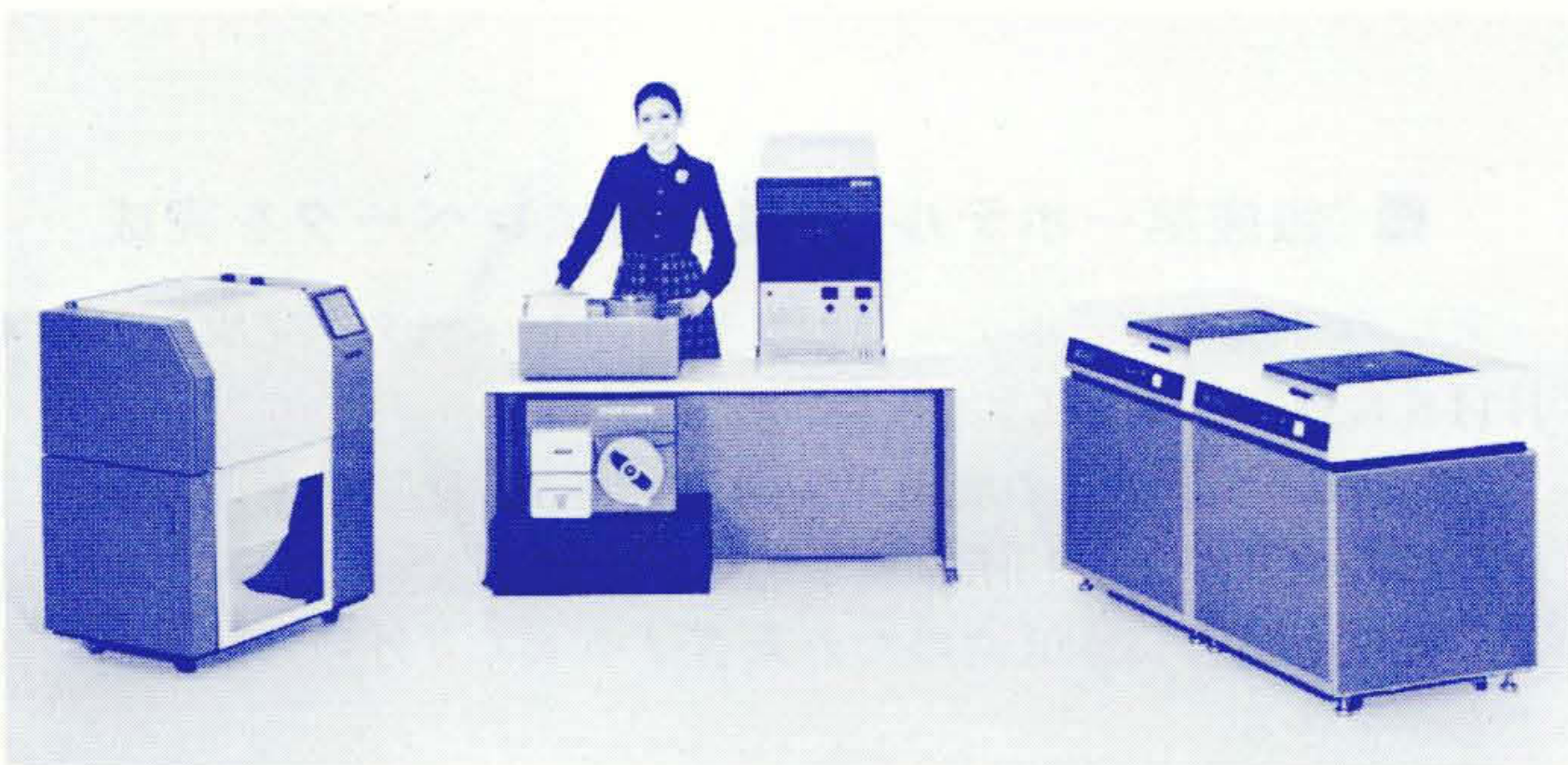
右：磁気ディスク装置、中央：処理装置およびディスプレイと紙テープ装置、左：ラインプリンタ(高速印字装置)
