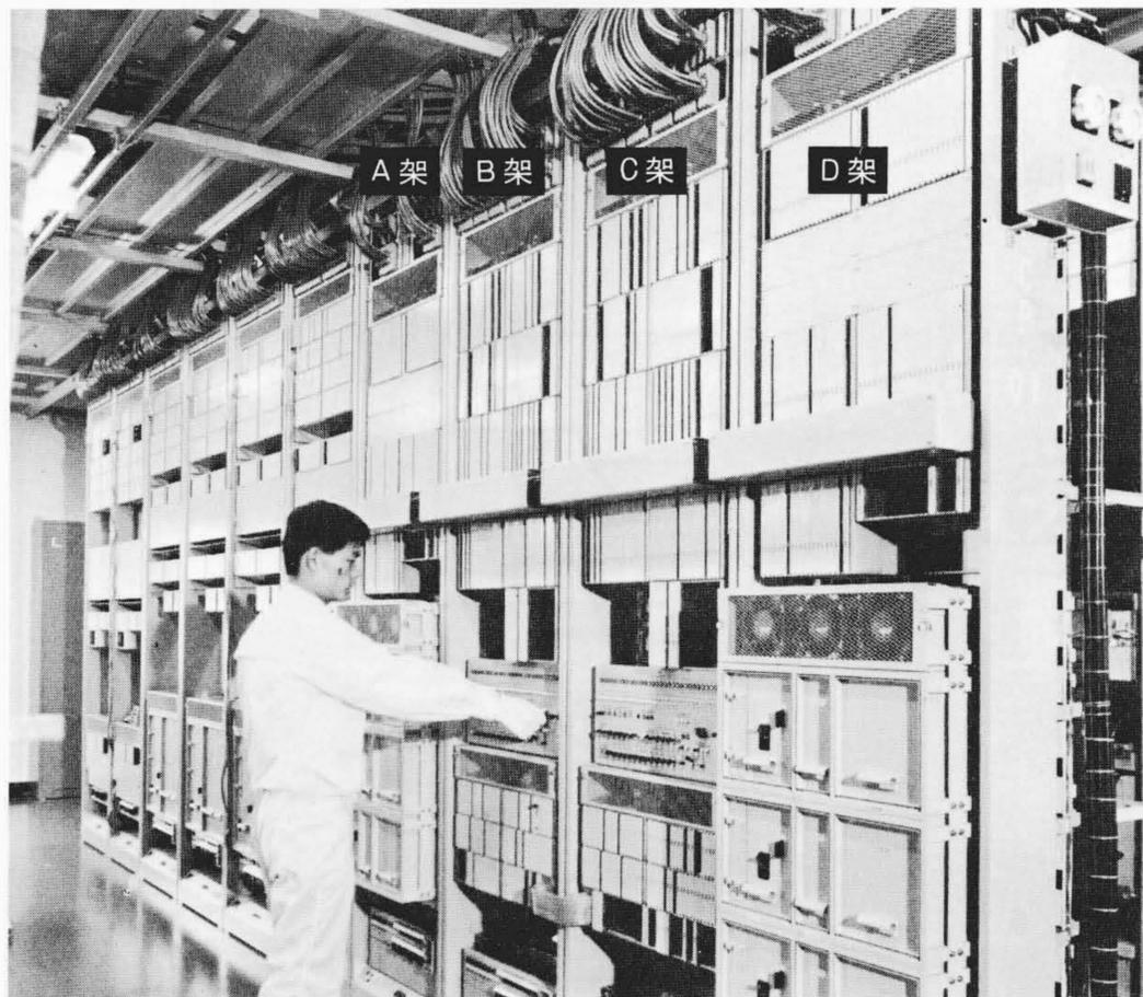
図3 中央処理系装置 中央処理装置はA, B, C, D架の4架から成り、このうちB, C架は中央制御装置, A, D架はデータチャネル装置である。記憶装置の一つ、一時記憶装置が中央処理装置に併置される。
