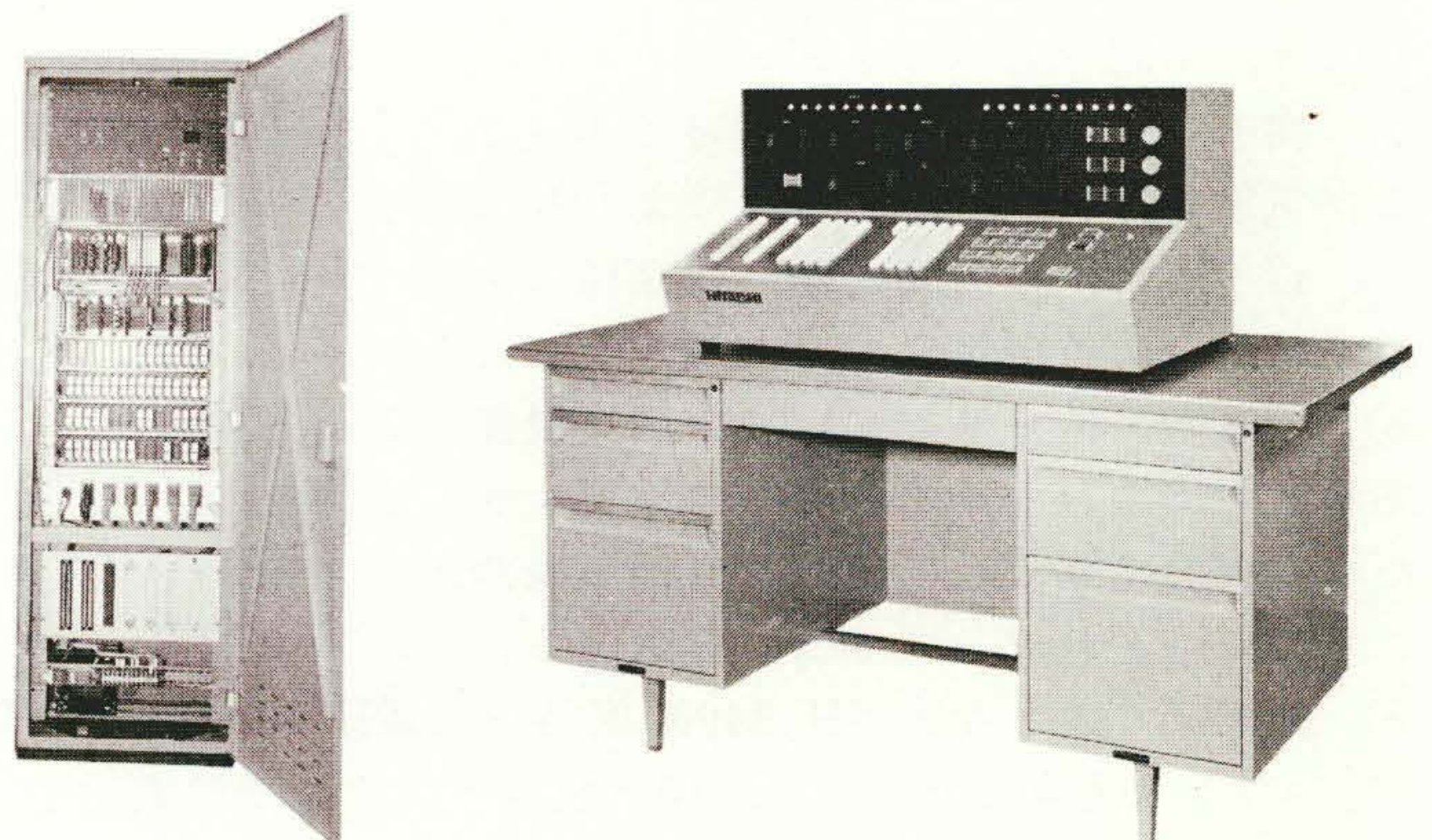
図4 ローカルステーションとオペレータコンソール
