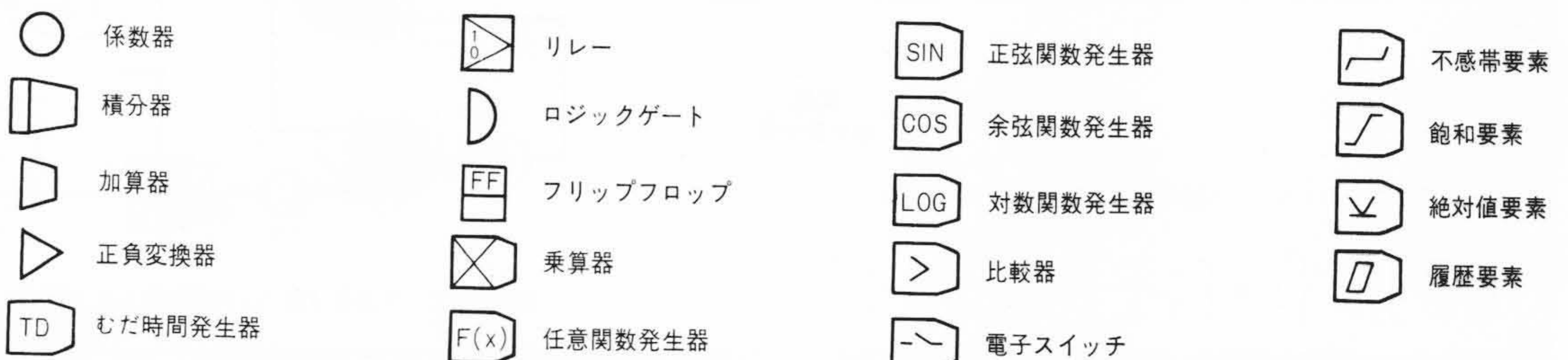
図3 ALS-200Xのパッチ板 卓上形計算機ALS-200Xのパッチ板の図面と記号説明である。
