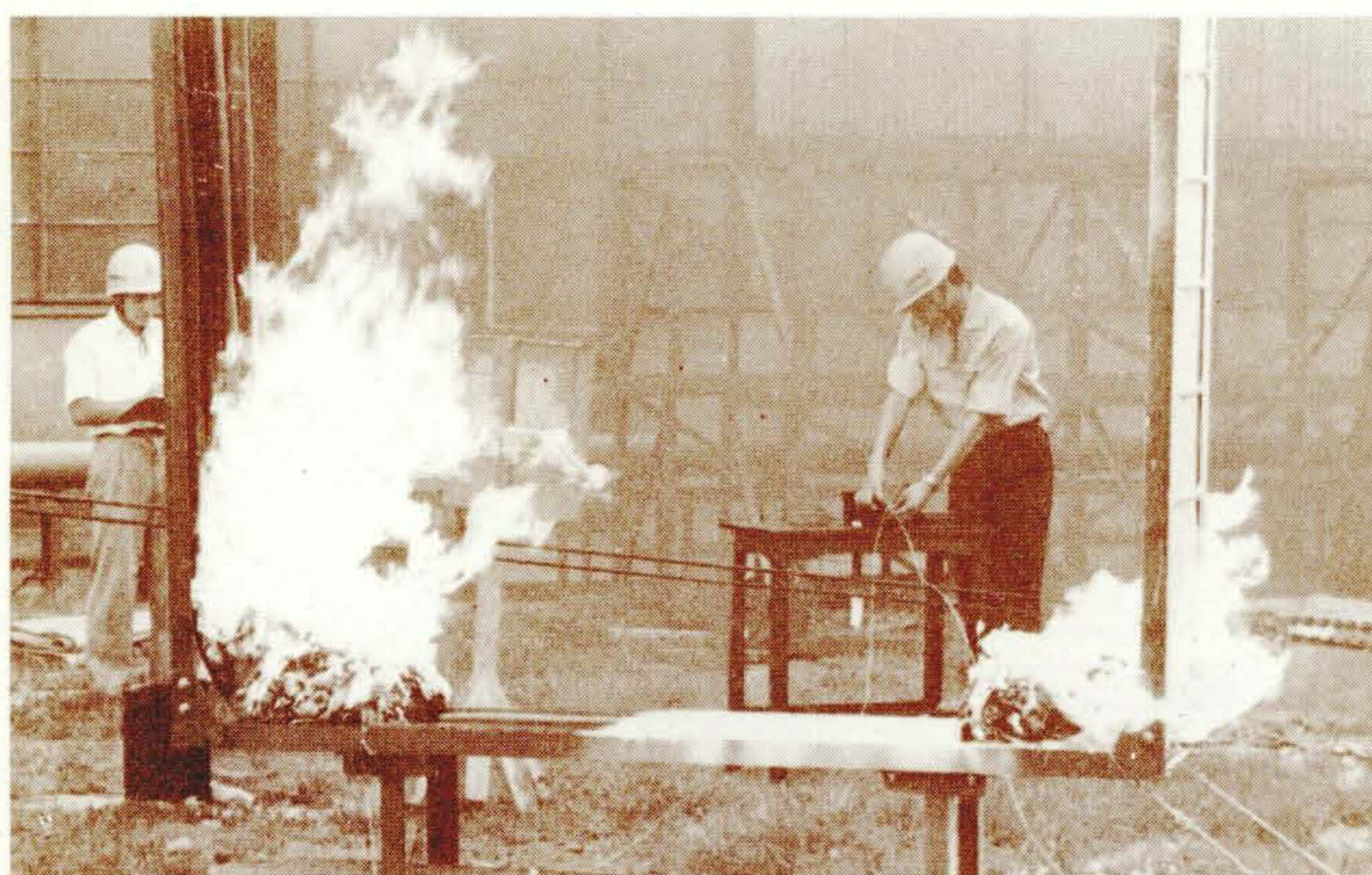
フレイムマスチック塗布なし（左側） フレイムマスチック塗布あり（右側） 図 1 燃焼状況試験
