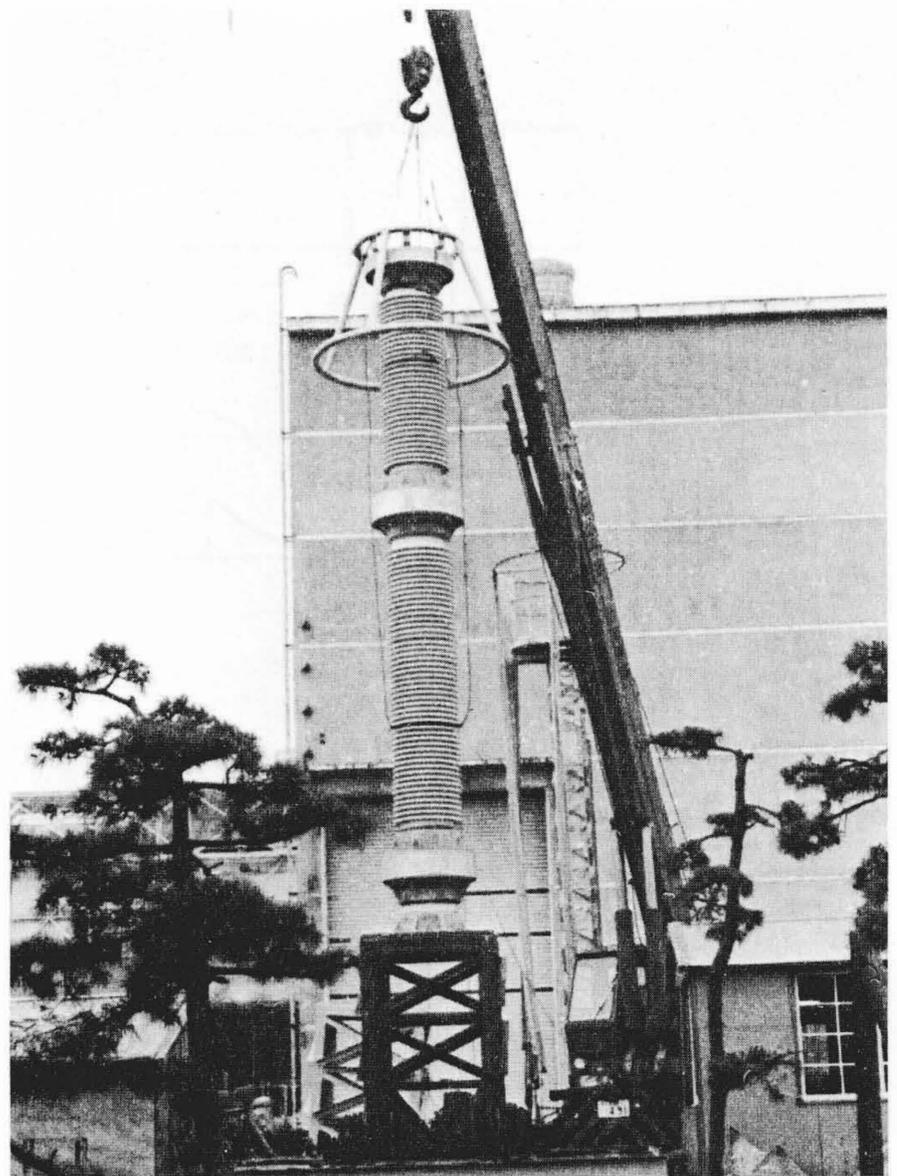
図17 耐震試験状況 共振周波数において0.3Gの加速度で正弦波3波の加振を行ない、十分耐えることを確認した。
