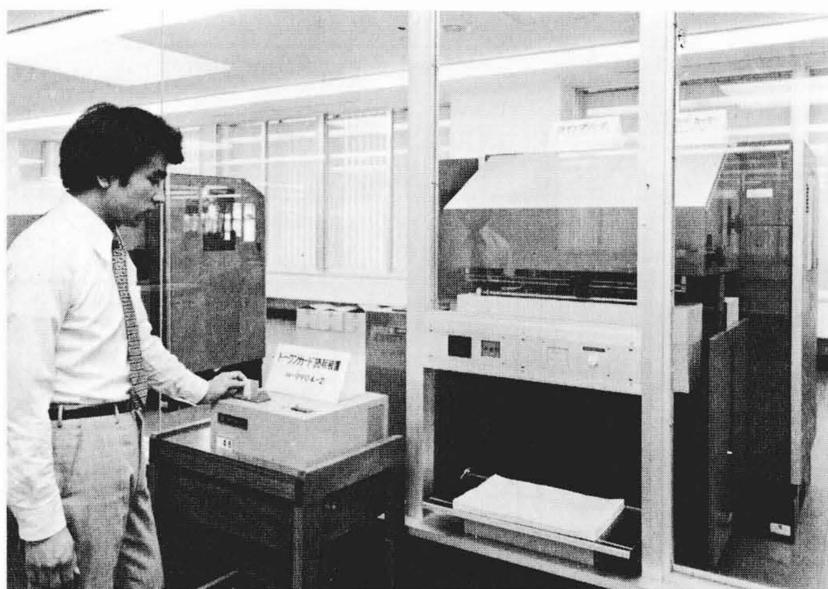
図4 トークン・カード読取機とラインプリンタ 利用者がトークン・カードを差し込むと終了したジョブの結果が出力される。用紙は最後のページで切断され、図の位置へ落下する。
