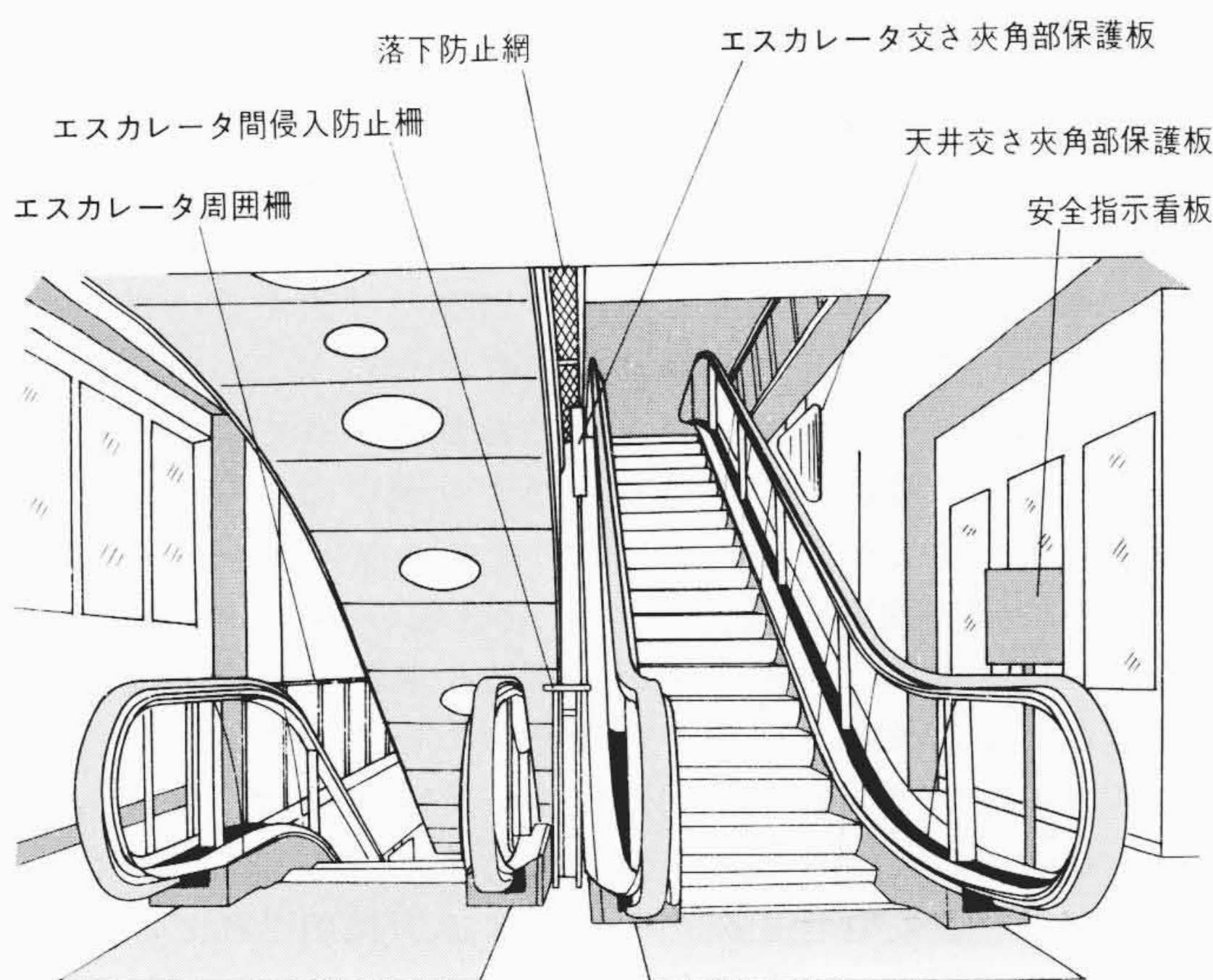
図1 交差設置形エスカレータの安全設備 エスカレータと建物との間にすきまや夾角部があるので、ここに保護装置が必要である。
