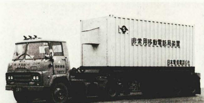
図4 トレーラに搭載した非常用自動交換機
