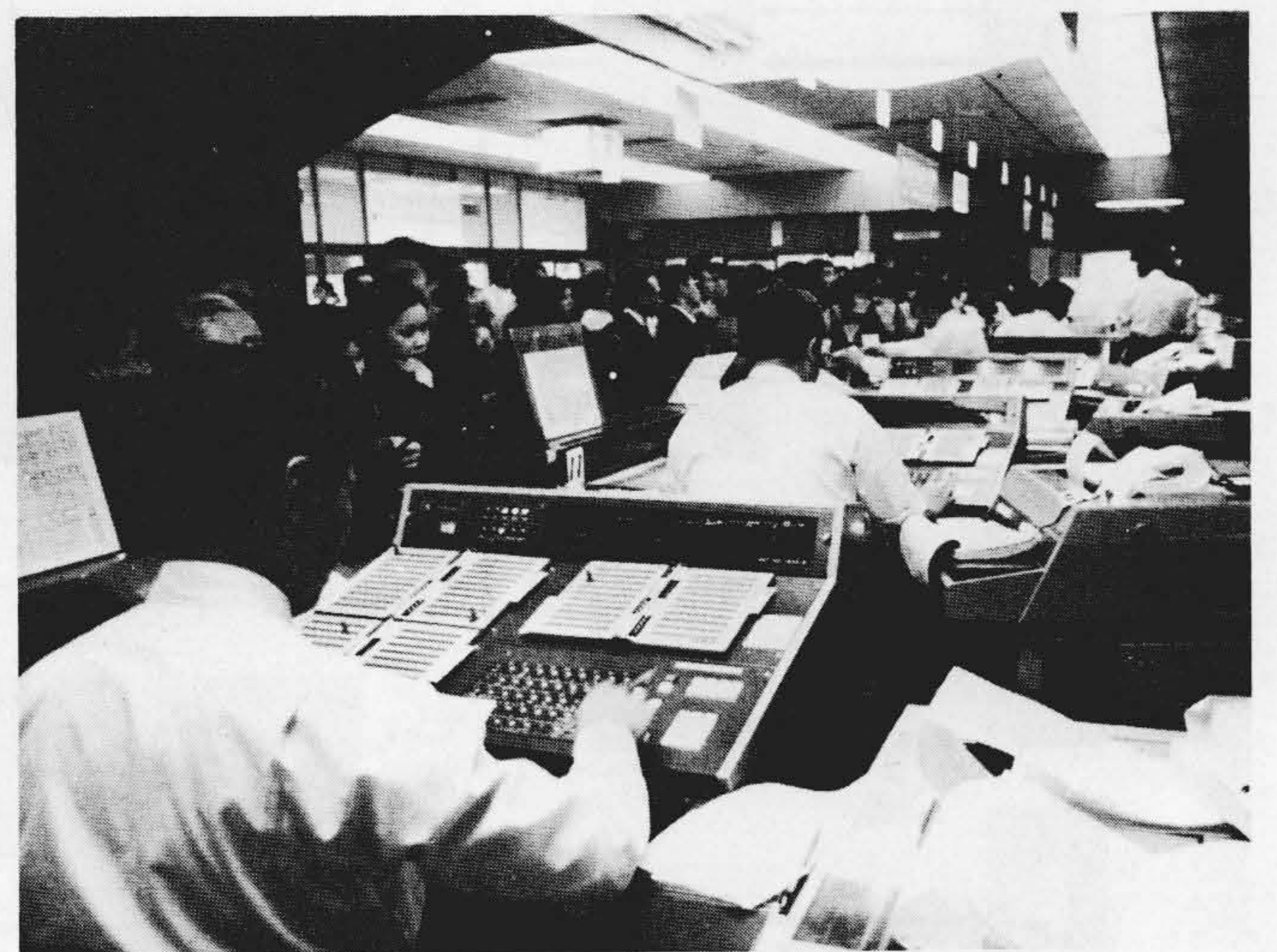
図1 装置の外観 左：座席表示器を取り付けた操作制御卓、右：印刷発行機を示す。
