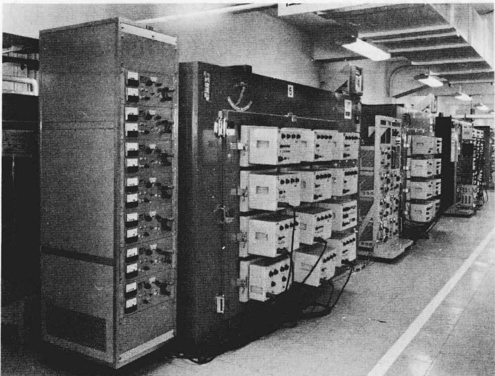
図 4 高温動作寿命試験装置 集積回路の高温動作寿命試験装置の例。バイポーラ デジタル形 IC の場合は、通常直流印加試験が行なわれている。
