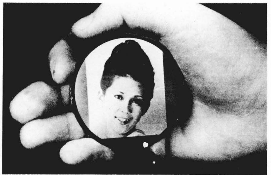
図11 PLZTを用いた反射形画像蓄積・表示素子に定着した画像直径55mmφのPLZT-7.6/70/30の薄板で作ったFE/PC素子に定着した画像で裏面が反射鏡になっているので周囲光で画像を直視できる。
