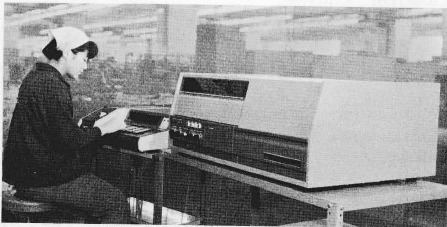
図7 カラーカリキュレータシステム 307形と卓上電子計算機とをオンラインで接続し, 測定と同時に表色値を計算することにより, 混色の一次処方または修正処方を求める。
