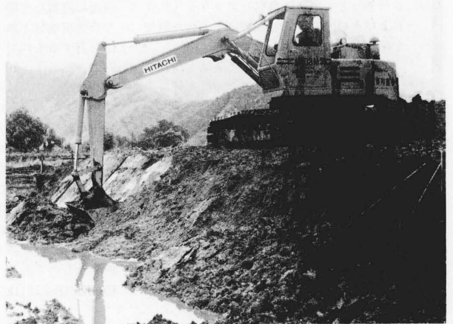
図13 日立UH03M形湿地用油圧ショベル 走行駆動部にHMA50Aが使用されている。
