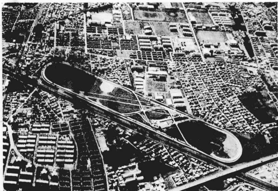
図 4 CVS東村山実験場ガイドウェイ 総延長 4.5km, スーパーウェイ一周約 2 km のガイドウェイから構成されている。
