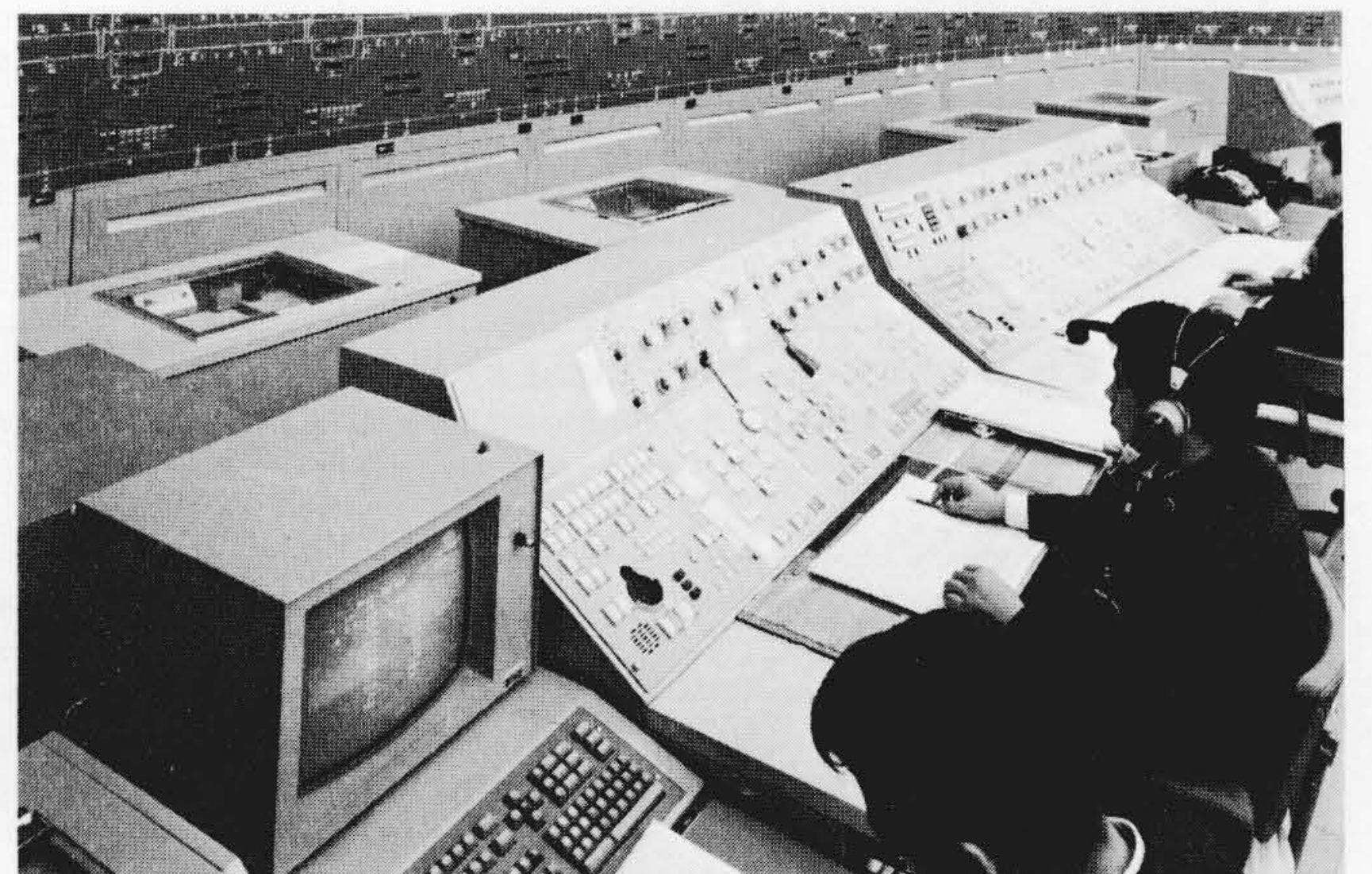
図1 新幹線列車運転指令室 指令員はキャラクタディスプレイを使用して電子計算機と会話する。
