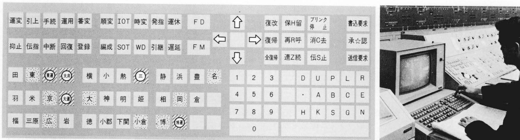
図9 CDけん盤(左)及び画面例(右) 指令入力項目、駅名キーなど、コムトラック専用に製作したCDのファンクションけん盤と、画面の一例を示す。
