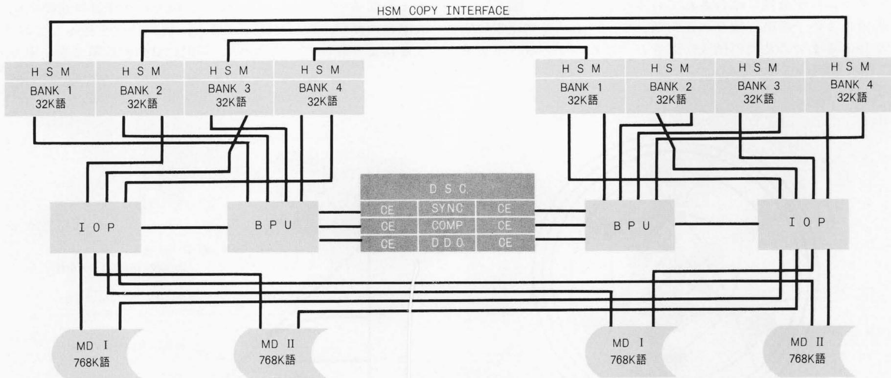
注：英略字説明 HSM=コアメモリ記憶装置 BPU=演算装置 IOP=入出力処理装置 DSC=二重系監視装置 MD=磁気ドラム記憶装置
