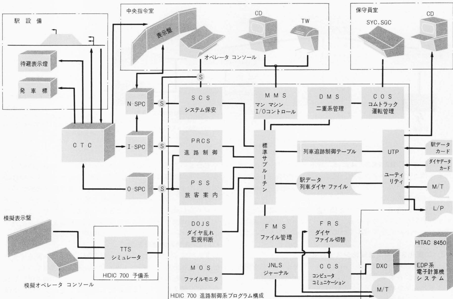
図2 コムトラック進路制御系システム構成図 HIDIC 700進路制御系は、駅データファイル、ダイヤファイルを中心に、14個のサブシステムモジュールで構成されている。
