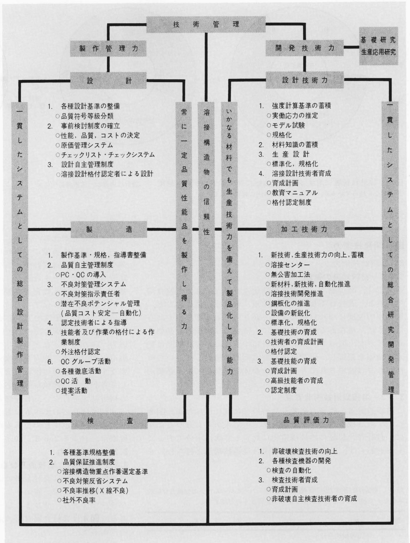
図2 溶接構造物の信頼性向上具体策 溶接構造物の信頼性を向上させるためには、各部門において具体策を強力に推進する必要がある。
