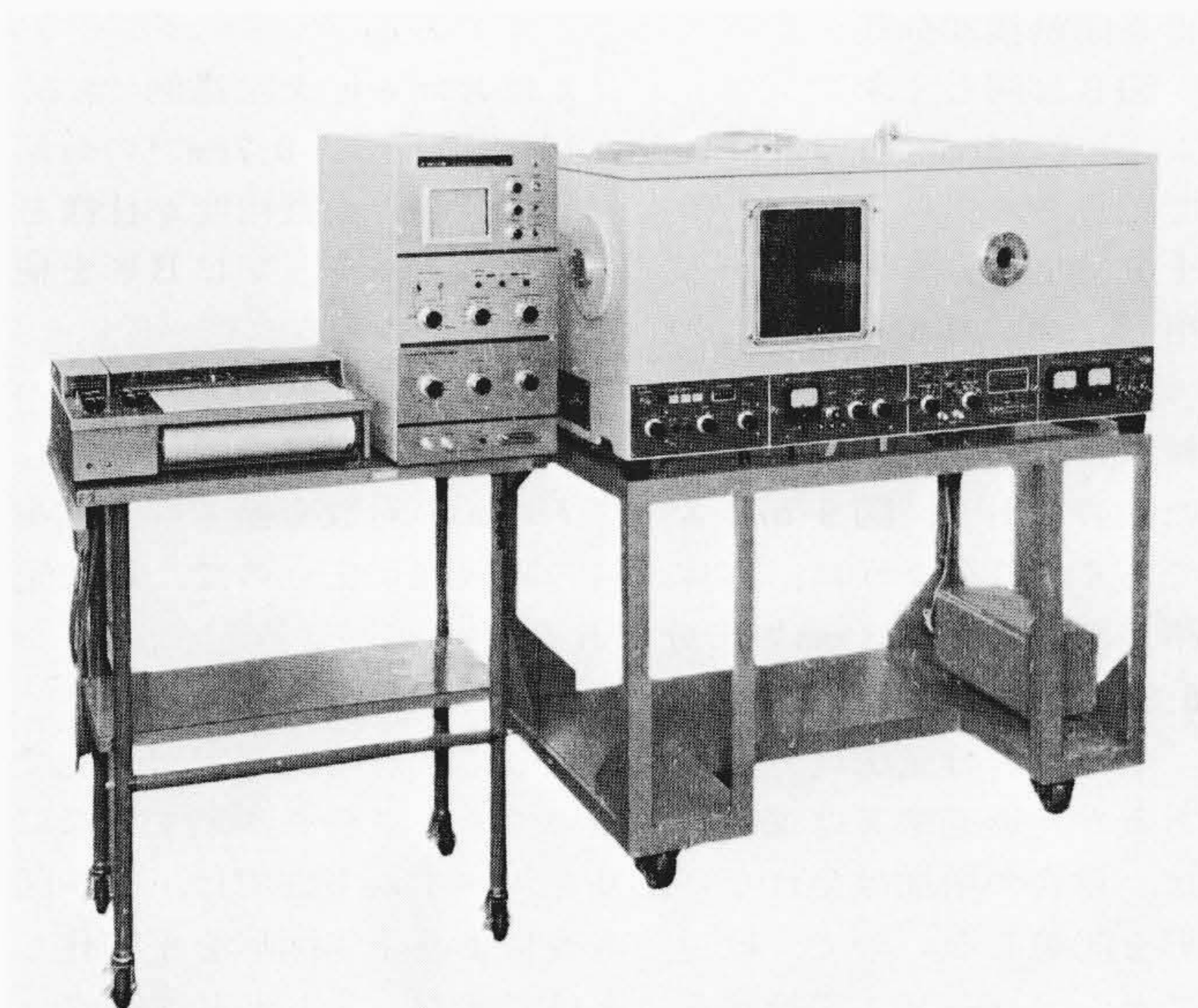
図4 リアルタイムフーリエ変換遠赤外分光装置 左よりペンレコーダ、専用フーリエ変換装置及び干渉計本体から成る(大きさは図5を参照)。
