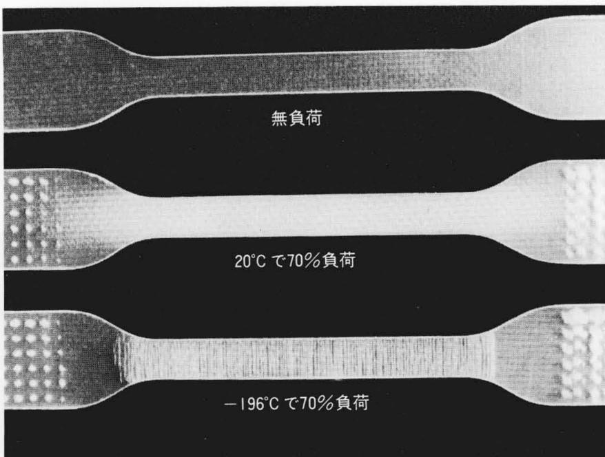
図10 引張り試験片 20°Cと-196°Cでは破断の過程が違う。
