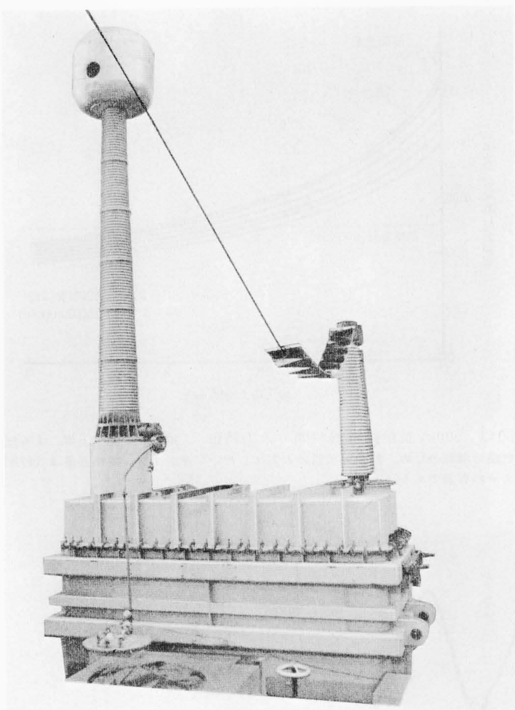
図9 500kV制動抵抗器電圧ユニット 線路側250kV部分を製作し、接地側は外部で分圧抵抗器を接続し衝撃電圧試験を行なった。
