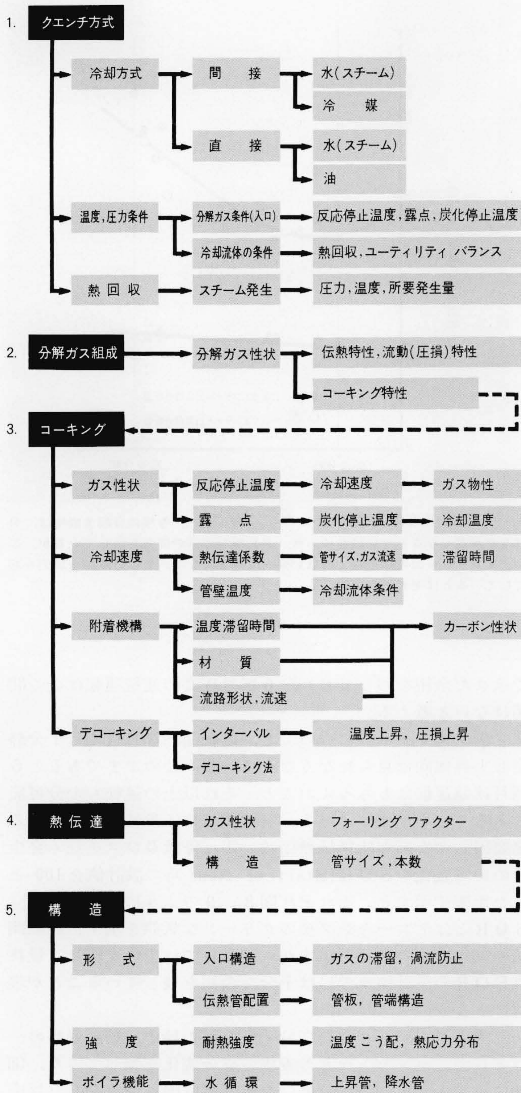
図5 クエンチクーラーの性能に関する要因の関連図 クエンチクーラーの設計的関連要因は複雑を極めており、いずれの関係も理論的説明は難しく、それぞれの要因の重視の仕方は開発者の主観に負うところが多い。
