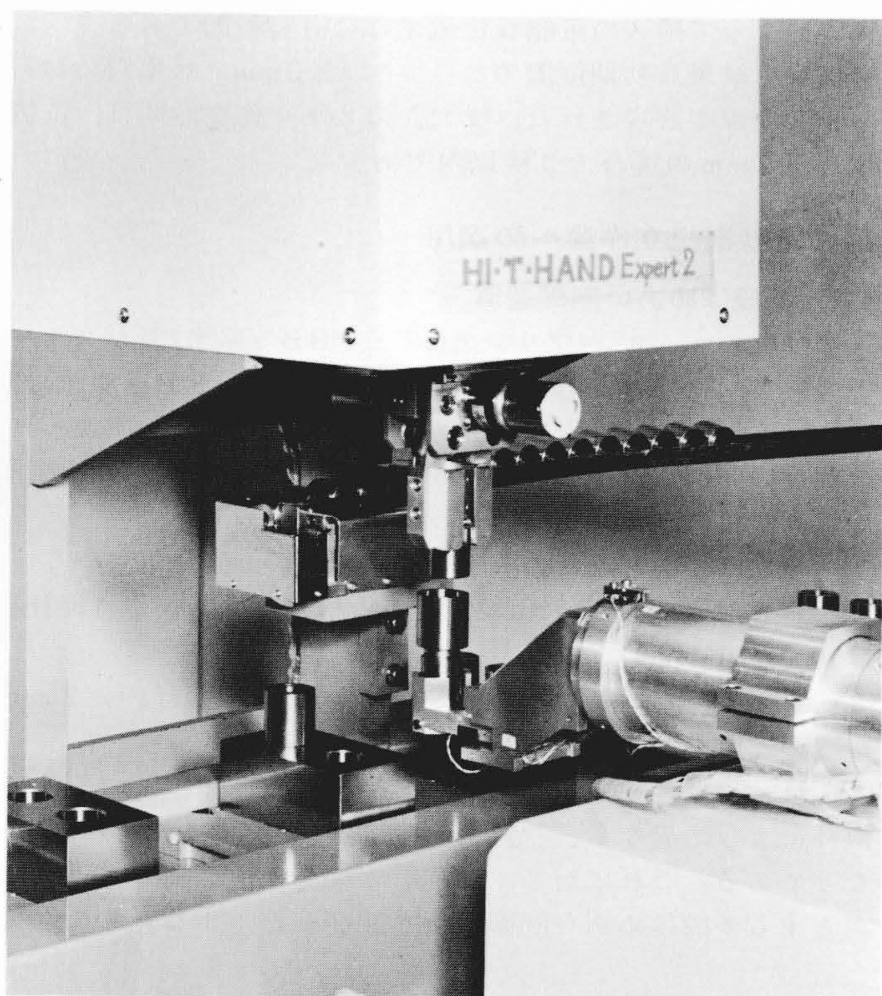
図7 “HI-T-HAND Expert-2” クリアランス 20\mu のはめあいを、2本の手の連係動作で行なっている。
