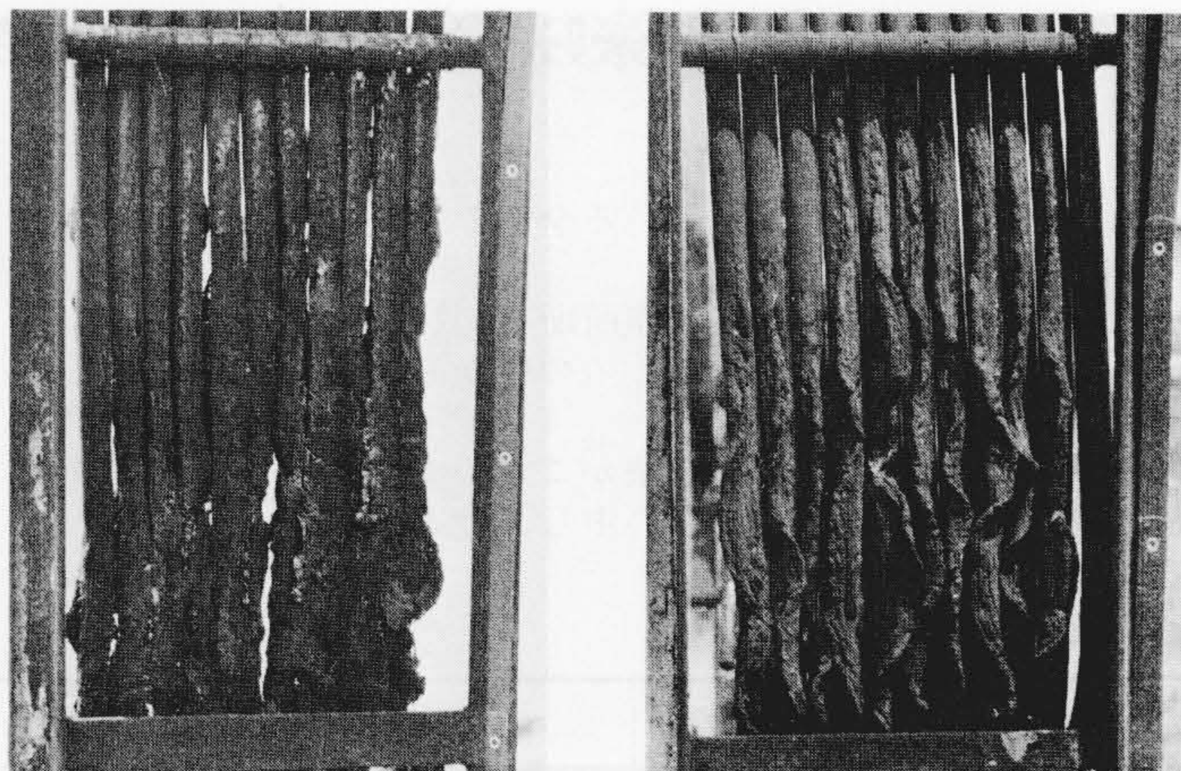
図9 燃焼後ケーブルの損傷状況(左：通常品，右：低煙害品)
